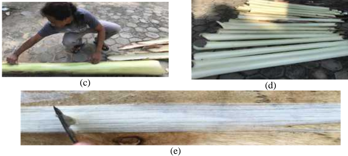
Gambar 1. Proses awal pengolahan batang pisang. (a) penebangan pohon pisang (b) penimbangan berat awal batang pisang yang sudah ditebang (c) pembersihan dan pengelupasan pelepah pisang (d) pelepah pisang yang telah dikupas (e) proses scraping secara manual pada batang pisang basah untuk menghasilkan filamen benang
