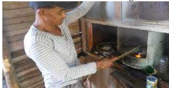
Gambar 5. Penggunaan Tabung Penangkap Uap untuk Mengurangi Pencemaran Merkuri
