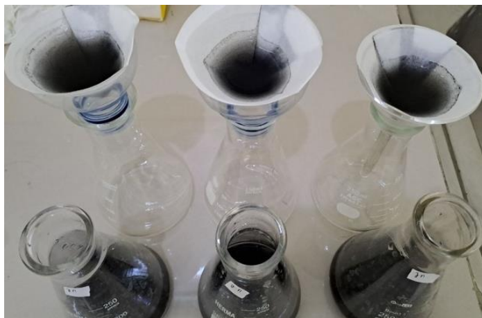
Gambar 2. Proses filtrasi hasil kontak sampel dengan arang aktif beragam aktivator
