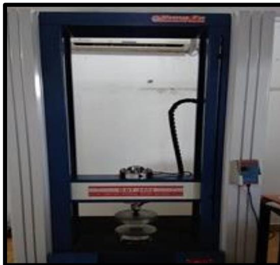
**Gambar 1. *Universal Testing Machine* untuk Pengujian Daya Tarik dan Elastisitas Kemasan Kertas.**
