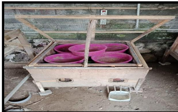
**Gambar 2. Reaktor *Continuous Flow Bin* Kotak Kasa Bagian Dalam yang Dimodifikasi Mashur (2020) dari Kusuma (2018); Edward, Arancon, & Sherman (2011).**
