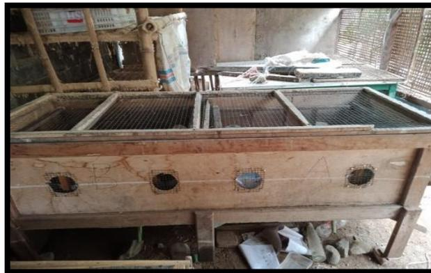
**Gambar 1. Reaktor *Continuous Flow Bin* yang Telah Dimodifikasi Mashur (2020) dari Kusuma (2018); Edward, Arancon, & Sherman (2011).**
